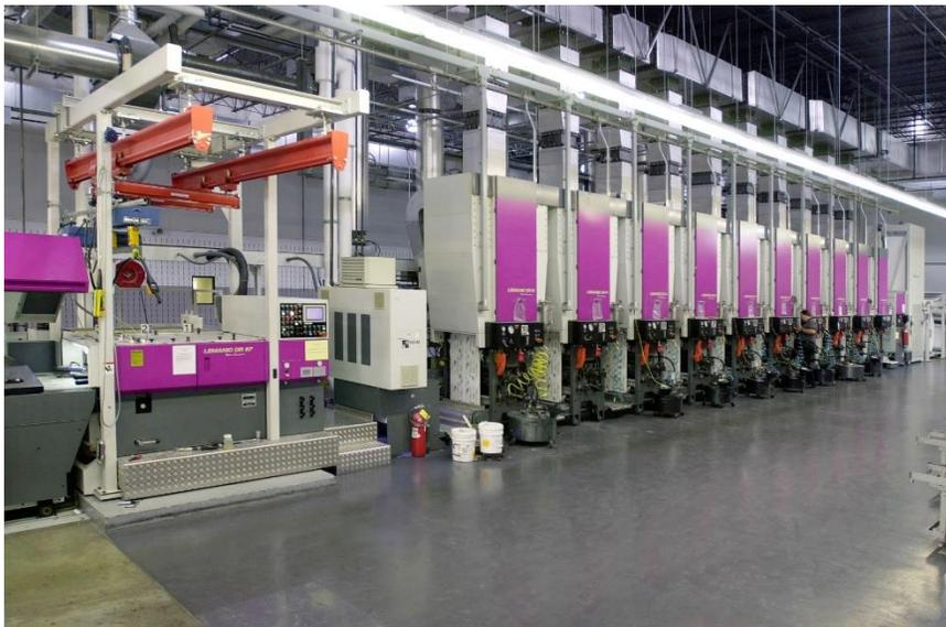
Eine Bobst Tiefdruckmaschine
